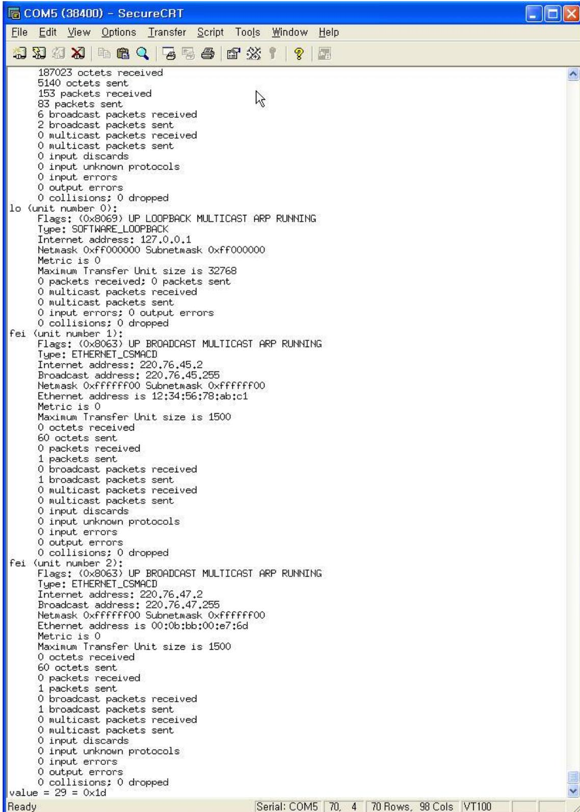
그림 5. PMC Ethernet Card 를 사용했을 경우 Boot From Network
